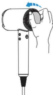
Entfernen Sie die Lufteinlassabdeckung, indem Sie sie gegen den Uhrzeigersinn drehen.
