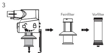
Drehen Sie gegen den Uhrzeigersinn, um die Filter zu entfernen.
