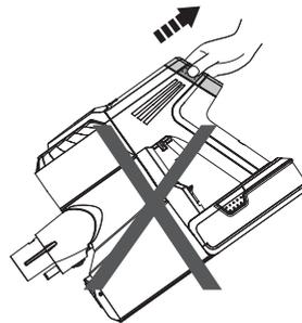
Bitte das Gerät beim Aus- und Einbau des HEPA-Filters nach unten halten, damit kein Staub in den Luftkanal des Motors gelangt.
