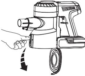
Drücken Sie die Entriegelungstaste des Staubsaugers seitlich am Staubbehälter, um ihn auszuleeren.
