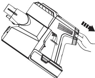
Drücken Sie die HEPA-Entriegelungstaste und ziehen Sie den Filter für die Reinigung vorsichtig heraus. Nehmen Sie das Gerät nicht ohne zuvor eingesetzten HEPA-Filter in Betrieb.
