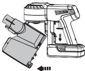
Um den Staubbehälter gründlicher zu reinigen, drücken Sie seine Freigabetaste, um ihn vom Gerät zu lösen.
