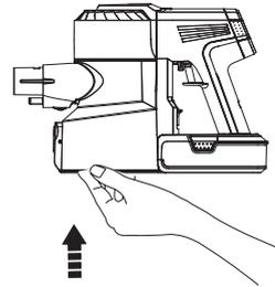
Schließen Sie die Staubbehälterklappe und lassen Sie sie einrasten.
