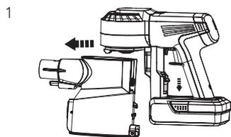
Drücken Sie die Staubbehälter-Entriegelungstaste, um den Staubbehälter herauszunehmen.
