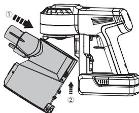
Halten Sie den Staubbehälter zum erneuten Anbringen schräg und stecken Sie seine Oberseite in den Haken am Hauptgerät. Drücken Sie den Staubbehälter nach oben, bis der Haken im Schlitz des Staubbehälters einhakt. Er rastet dann ein.
