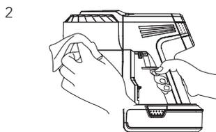
Reinigen Sie ihn mit einem feuchten Tuch. Achten Sie dabei darauf, dass kein Wasser in das Gehäuse des Hauptgeräts und den Akku eindringt.
