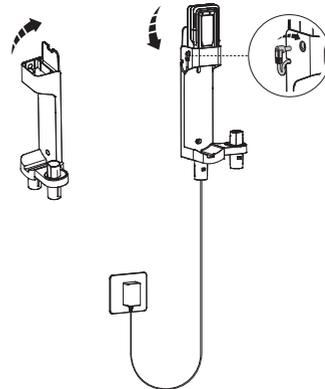
Sie können den Akku auch separat aufladen: Öffnen Sie die obere Abdeckung und setzen Sie den Akku in die obere Aufnahme ein. Schließen Sie dann das Ladegerät an eine Steckdose und die Ladebuchse an. Drei nacheinander aufblinkende blaue Lämpchen zeigen den korrekten Ladevorgang an.
