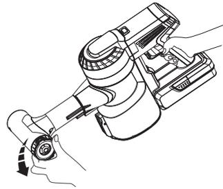
Lassen Sie das Gerät im MAX-Modus laufen und drehen Sie die seitliche Abdeckung, um den verschmutzten Vorfilter zu reinigen.
