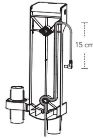
1. Installieren Sie die Zubehörhalterung an der Schiene der Dockingstation für Wandmontage und drücken Sie den Clip in den Schlitz, um die Montage abzuschließen.
