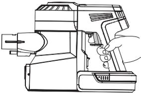
Betätigen Sie den Einschalter, um den Staubsauger zu starten. Betätigen Sie die Verriegelung des Einschalthebels und halten Sie den Einschalthebel für den Dauerbetrieb gedrückt.
