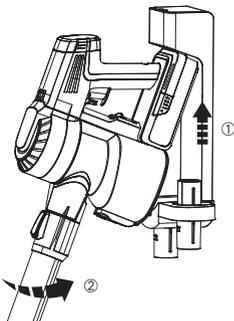
Setzen Sie das Gerät in die Dockingstation ein.
