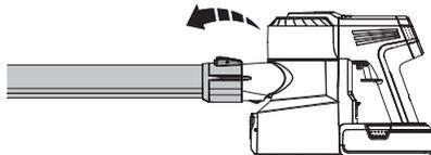
Drücken Sie die Freigabetaste, um das Rohr zu entfernen.
