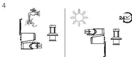
Reinigen Sie Staubbehälter und Feinfilter unter kaltem, fließendem Wasser. Lassen Sie sie vollständig an der Luft trocknen, bevor Sie sie erneut einsetzen.
