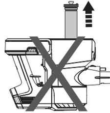
Bitte das Gerät beim Aus- und Einbau des Filters nach unten halten, damit kein Staub in den Luftkanal des Motors gelangt.
