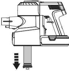
Vergewissern Sie sich, dass das Gerät vor der Reinigung ausgeschaltet wurde und entfernen Sie den verschmutzten Vorfilter aus der Feinfilterhalterung.
