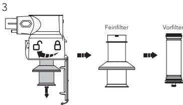
Drehen Sie gegen den Uhrzeigersinn, um die Filter zu entfernen.
