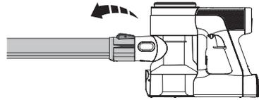
Entriegelungstaste drücken und Rohr herausziehen.
