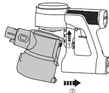
Halten Sie den Staubbehälter zum erneuten Anbringen schräg und stecken Sie seine Oberseite in den Haken am Hauptgerät. Drücken Sie ihn nach oben, bis der Haken im Schlitz des Staubbehälters einhakt. Er rastet dann ein.
