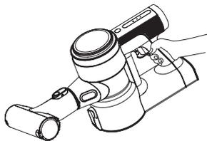
Einen sauberen Filter in das Gerät einsetzen. Den verschmutzten Vorfilter in das Reinigungsgerät schieben und das Reinigungsgerät an das Gerät anschließen.
