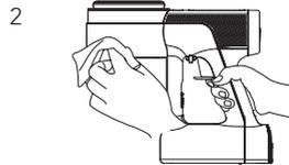
Reinigen Sie ihn mit einem feuchten Tuch. Achten Sie dabei darauf, dass kein Wasser in das Gehäuse des Hauptgeräts und den Akku eindringt.
