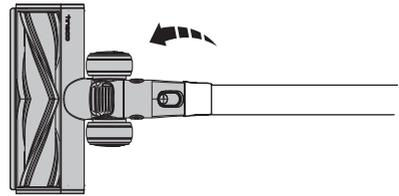
Entriegelungstaste drücken und Turbobürste abziehen.
