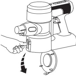
Drücken Sie die Entriegelungstaste des Staubsaugens seitlich am Staubbehälter, um ihn auszuleeren.
