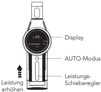
Standardmäßig startet das Gerät im AUTO-Modus. Wischen Sie den Leistungs-Schieberegler, um in den manuellen Modus zu wechseln. Halten Sie die AUTO-Taste länger gedrückt, um wieder in den AUTO-Modus zu wechseln.
