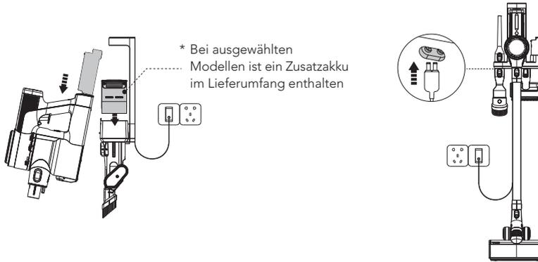
Schließen Sie das Steckernetzteil an der Dockingstation und einer Steckdose an.
