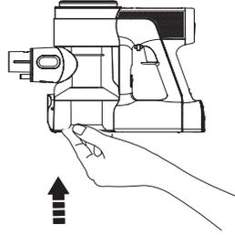
Schließen Sie die Staubbehälterklappe und lassen Sie sie einrasten.
