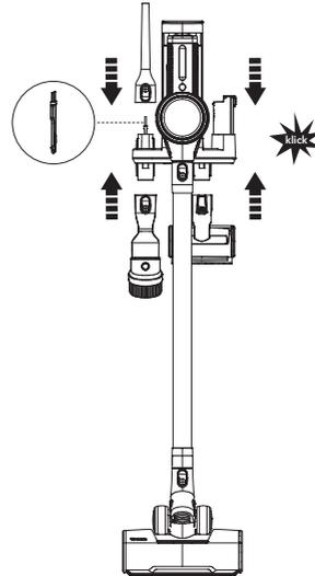
Um Schäden an den Borsten zu vermeiden, bringen Sie nach Gebrauch stets die Zubehörteile an der Dockingstation an.
