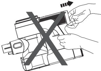
Drücken Sie die HEPA-Entriegelungstaste und ziehen Sie den Filter für die Reinigung vorsichtig heraus. Nehmen Sie das Gerät nicht ohne zuvor eingesetzten HEPA-Filter in Betrieb.
