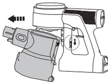
Drücken Sie zur gründlicheren Reinigung des Staubbehälters seine Entriegelungstaste, um ihn vollständig vom Gerät abzunehmen.
