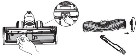
Reinigen Sie nach dem Entfernen der Bürstenrolle vorsichtig die Bürsten- und die Saugöffnung. Beseitigen Sie mit dem Haarreinigungswerkzeug von Tineco Rückstände, die sich um die Rolle gewickelt haben.
