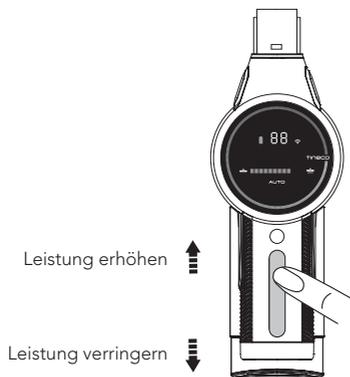
Wischen Sie im AUTO-Modus den Leistungs-Schiebereglern, um in den manuellen Modus zu wechseln. Im manuellen Modus können Sie die Leistung nach Bedarf steuern.
