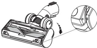
Setzen Sie die Bürstenrolle wieder vollständig in die Bürstenöffnung ein und drehen Sie die Endkappe im Uhrzeigersinn, bis sie wieder sicher einrastet.
