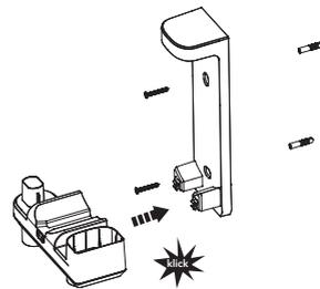
Setzen Sie beide Komponenten der Halterung mit einem „klick“ zusammen, was den korrekten Zusammenbau bestätigt. Sobald dies abgeschlossen ist, befestigen Sie die Dockingstation mit den von Tineco mitgelieferten Schrauben an der Wand.
