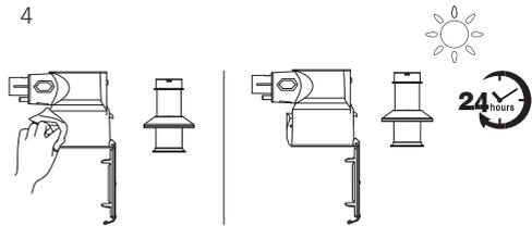
Wischen Sie Staubbehälter und Feinfilter mit einem nassen Lappen ab. Lassen Sie sie vollständig an der Luft trocknen, bevor Sie sie erneut einsetzen.
