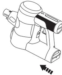
Schieben Sie den Akku zum Wechseln in den Schlitz auf der Unterseite des Hauptgeräts. Bei korrektem Einbau rastet der Akku hörbar ein.
