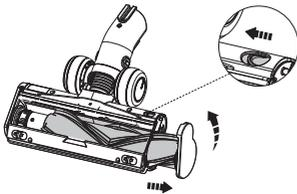
Schieben Sie den Schalter, um die Endkappe der Bürstenrolle zu öffnen, und drehen Sie die Kappe zum Herausziehen der Bürstenrolle gegen den Uhrzeigersinn.
