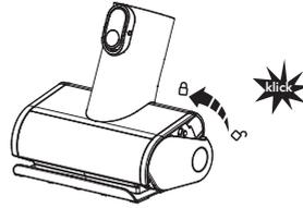
Setzen Sie die Bürstenrolle vollständig und schräg wieder ein. Drücken Sie sie nach oben, bis sie wieder sicher einrastet.
