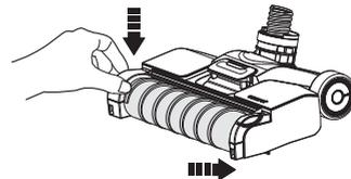
Setzen Sie die Bürstenrolle wieder ein, indem Sie das Bürstenrollenende in die rechte Seite der Halterung einsetzen und die Zuglasche durch Drücken nach unten einrasten lassen.
