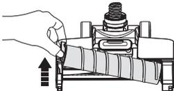
Entfernen Sie die Bürstenrolle, indem Sie die Bürstenrollenlasche greifen und nach oben ziehen.
