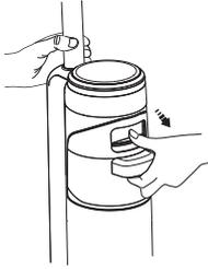
Drücken Sie die Entriegelungstaste für den Friskwasserbehälter, um ihn vom Gerät zu entfernen.
