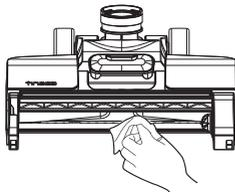
Entfernen Sie Haare und Schmutz mit einem Papiertuch oder einem feuchten Tuch aus der Bürstenrollenkammer und der Öffnung.
