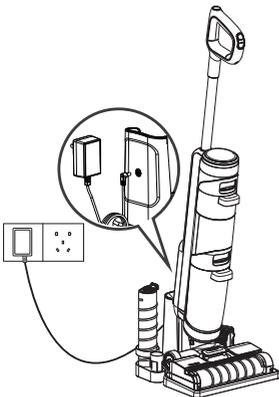
Um das Gerät aufzuladen, stellen Sie es auf die Ladestation und schließen Sie das Steckernetzteil an einer Steckdose an.
