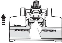
Halten Sie den Knopf gedrückt und ziehen Sie den vorderen Griff nach oben, um die Abdeckung zu entfernen.
