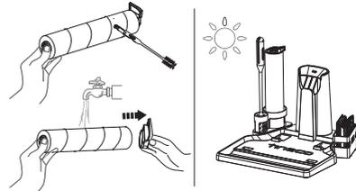
Entfernen Sie die Bürstenrollenlasche. Entfernen Sie mit dem Reinigungswerkzeug die um die Bürstenrolle gewickelten Haare und Rückstände, und spülen Sie sie mit Wasser ab. Setzen Sie die Bürstenrolle wieder in den Zubehörhalter ein, und lassen Sie sie vollständig trocknen, bevor Sie sie wieder in das Gerät einsetzen.
