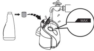
Öffnen Sie den Behälterdeckel, und füllen Sie den Behälter bis zur Markierung Max mit Leitungswasser. Wenn eine gründliche Reinigung erforderlich ist, fügen Sie dem FWB einen Flaschenverschluss der Lösung hinzu, und schließen Sie den Verschluss fest.
