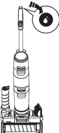
1. Das Gerät nach der Verwendung wieder auf der Ladestation abstellen. Wenn das Symbol für die Selbstreinigung blinkt, drücken Sie die Selbstreinigungstaste und starten Sie den Vorgang.
