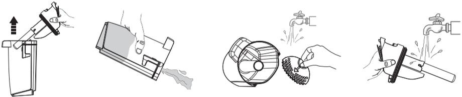
Wenn der Filter und der Schwimmer verstopft sind, spülen Sie sie mit Wasser ab. Nehmen Sie den Filter aus dem Behälterdeckel, entfernen Sie den Schwimmer, und spülen Sie beide Teile mit Wasser ab.
