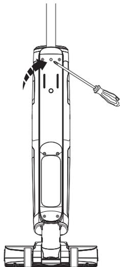
Um den Griff zusammenzusetzen, setzen Sie ihn in das Gerät ein, bis er hörbar einrastet.
