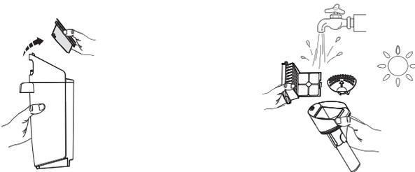
Fassen Sie den vertieften Bereich auf jeder Seite des HEPA-Filters und ziehen Sie ihn nach oben. Spülen Sie ihn unter fließendem Wasser ab. Der Filter muss vollständig trocken sein, bevor Sie ihn wieder in den Deckel des SMB einsetzen.
