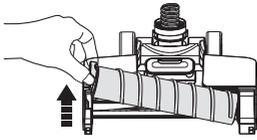
Entfernen Sie die Bürstenrolle, indem Sie die Bürstenrollenlasche greifen und nach oben ziehen.
