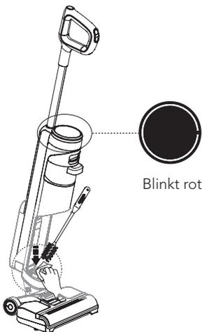
Wenn der LED-Ring rot blinkt, entfernen Sie den Schmutzwasserbehälter, und reinigen Sie den Schmutzsensoren mit einem feuchten Tuch oder dem 3-in-1-Reinigungswerkzeug.
