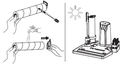
Entfernen Sie die Bürstenrollenlasche. Entfernen Sie mit dem Reinigungswerkzeug die um die Bürstenrolle gewickelten Haare und Rückstände, und spülen Sie sie mit Wasser ab. Setzen Sie die Bürstenrolle wieder in den Zubehöralter ein, und lassen Sie sie vollständig trocknen, bevor Sie sie wieder in das Gerät einsetzen.
