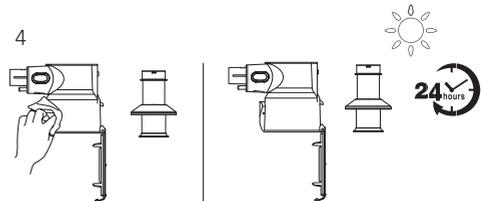
Wischen Sie Staubbehälter und Feinfilter mit einem nassen Lappen ab. Lassen Sie sie vollständig an der Luft trocknen, bevor Sie sie erneut einsetzen.
