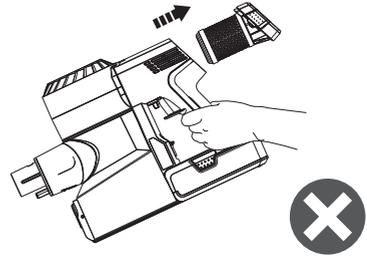
Bitte das Gerät beim Aus- und Einbau des HEPA-Filters nach unten halten, damit kein Staub in den Luftkanal des Motors gelangt.
