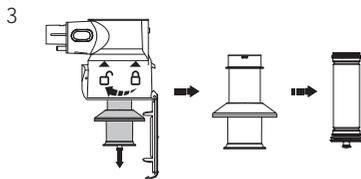
Drehen Sie gegen den Uhrzeigersinn, um die Filter zu entfernen.
