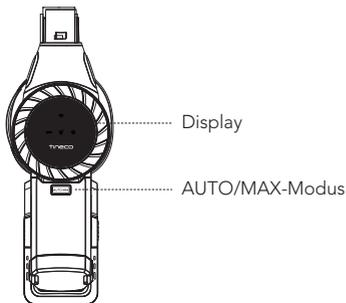
Standardmäßig startet das Gerät im AUTO-Modus. Drücken Sie nach 3 Sekunden die AUTO/MAX-Taste, um in den MAX-Modus zu wechseln, die Taste leuchtet auf.
