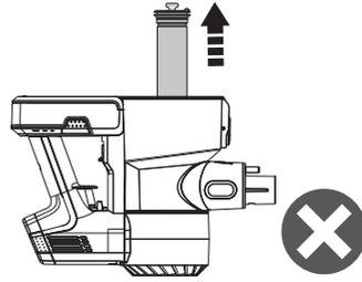
Vergewissern Sie sich, dass das Gerät vor der Reinigung ausgeschaltet wurde und entfernen Sie den verschmutzten Vorfilter aus der Feinfilterhalterung.
