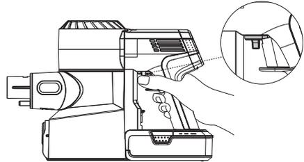
Betätigen Sie die Verriegelung des Einschalthebels und halten Sie den Einschalthebel für den Dauerbetrieb gedrückt.
