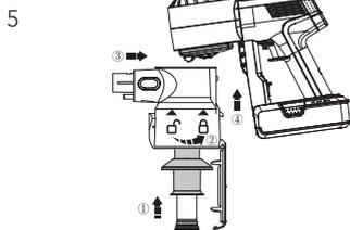
Setzen Sie nach der Reinigung den sauberen Vorfilter richtig in den Feinfilter ein und lassen ihn einrasten. Setzen Sie die Filter und den sauberen Staubbehälter erneut in das Gerät ein und schließen Sie die Staubbehälterklappe wieder.
