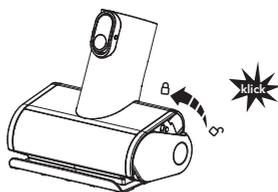
Setzen Sie die Bürstenrolle vollständig und schräg wieder ein. Drücken Sie sie nach oben, bis sie wieder sicher einrastet.
