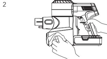
Reinigen Sie ihn mit einem feuchten Tuch. Achten Sie dabei darauf, dass kein Wasser in das Gehäuse des Hauptgeräts und den Akku eindringt.
