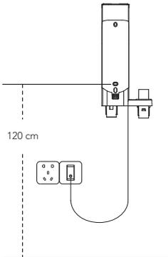
Legen Sie die beste Stelle für die Montage der Dockingstation an der Wand fest. Wir empfehlen, sie ab der unteren Befestigung in 120 cm Höhe zum Boden zu platzieren (möglicherweise muss sie je nach der tatsächlichen Situation angepasst werden).
