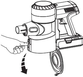
Drücken Sie nach Abschluss des Staubsaugens die Entriegelungstaste seitlich am Staubbehälter, um ihn auszuleeren.
