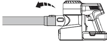
Drücken Sie die Freigabetaste, um das Rohr zu entfernen.
