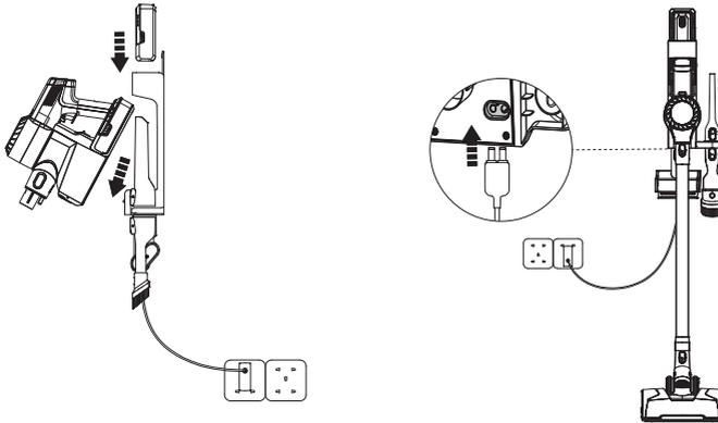
Schließen Sie das Steckernetzteil an der Dockingstation und einer Steckdose an. Sichern Sie zum Aufladen Hauptgerät und/oder Zusatzakku an der Dockingstation. Der Akku kann im Hauptgerät eingesetzt oder separat aufgeladen werden.
