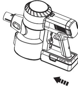
Schieben Sie den Akku zum Wechseln in den Schlitz auf der Unterseite des Hauptgeräts. Bei korrektem Einbau rastet der Akku hörbar ein.
