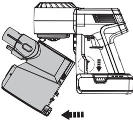
Um den Staubbehälter gründlicher zu reinigen, drücken Sie seine Freigabetaste, um ihn vom Gerät zu lösen.
