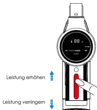
Wenn der Leistungsregler im Automatikbetrieb verschoben wird, schaltet das Gerät auf manuellen Betrieb um und die AUTO-Anzeige erlischt. Im manuellen Modus kann die Leistung nach Wunsch verstellt werden.
