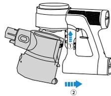
Den Staubbehälter schräg ansetzen. Die Aussparung am Staubbehälter muss in Richtung des Hakens am Hauptgerät zeigen. Behälter nach oben schieben, bis der Haken in die Aussparung eingreift. Beim Einrasten ertönt ein „Klickgeräusch“.
